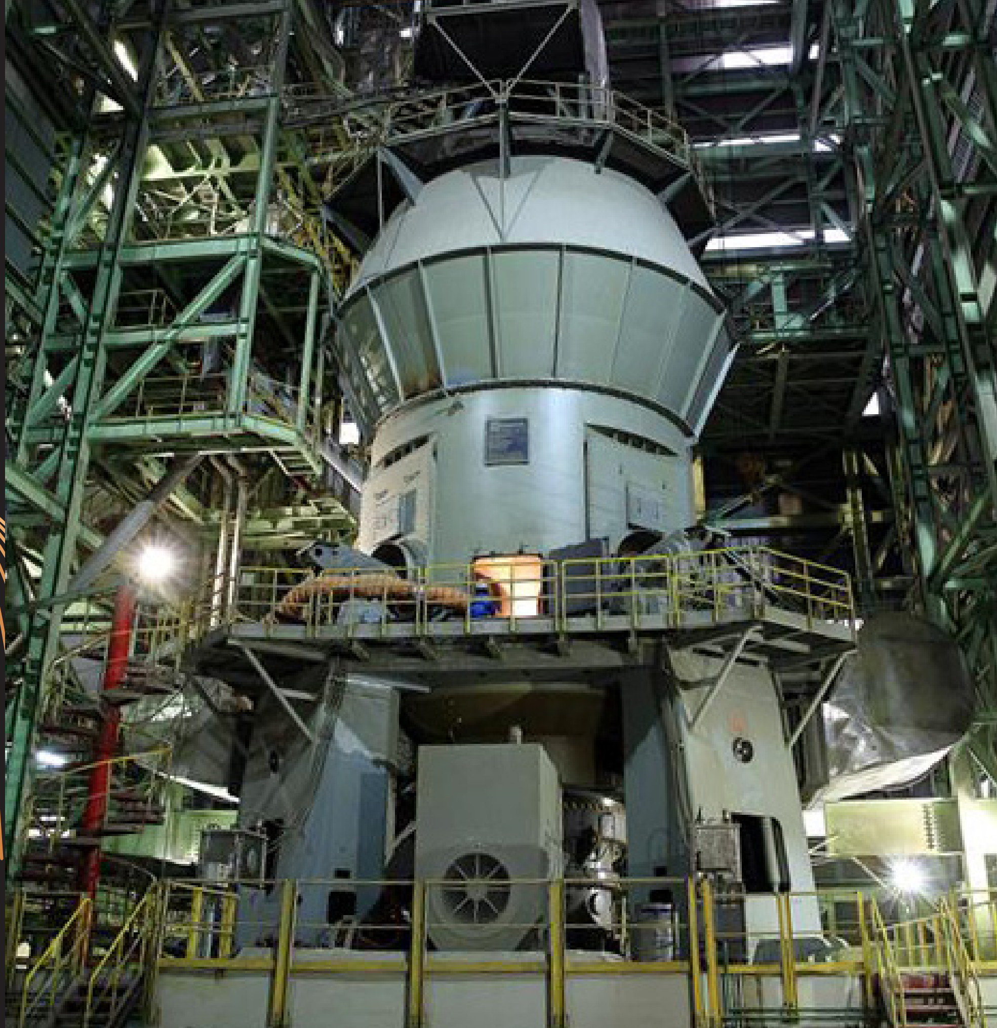
Pada 2014, Indocement menyelesaikan proyek vertical roller mill (VRM) di Plant 11, Kompleks Pabrik Citeureup dengan kapasitas produksi terpasang sebesar 1,9 juta ton semen per tahun.
